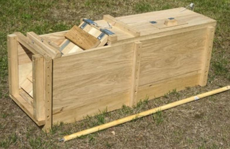
Schiebestab zum Einschrauben in Innenbrett der Fallenrückwand
