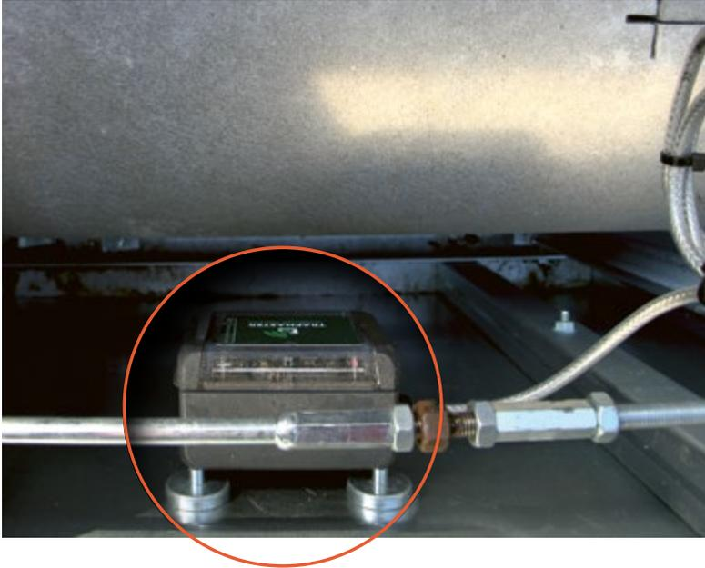
Elektronischer Fallenmelder an Betonrohrwippfalle (L.)
